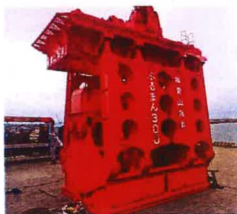
写真.2 法面均しクラブバケット
